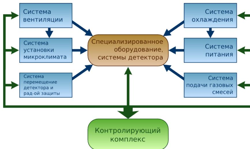
Рис. 2.49: Принципиальная схема взаимодействия систем инженерного комплекса детектора СЧТФ
