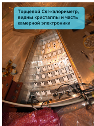
Медные трубки снимающие тепловую нагрузку с электроники (CsI)
