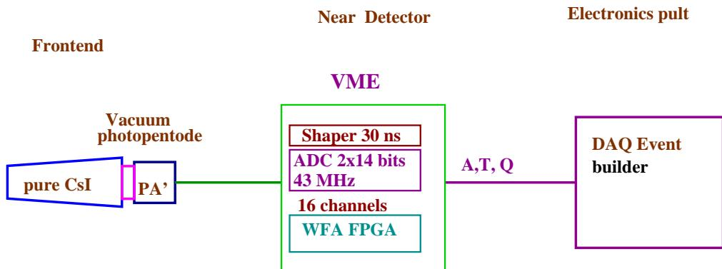
*Rис. 8: Схема электронного тракта калориметра.*
