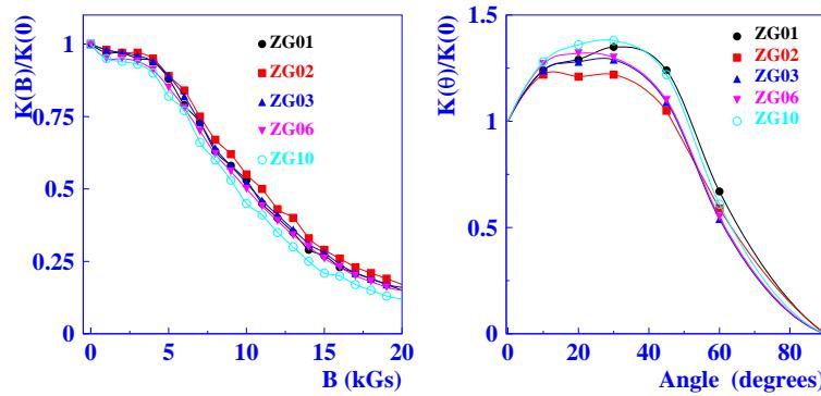
*Рис. 7:* Коэффициент усиления в зависимости от магнитного параллельного оси фотопентода – а). Сигнал с фотопентода в зависимости от угла между направлением магнитного поля и осью фотоприёмника.
