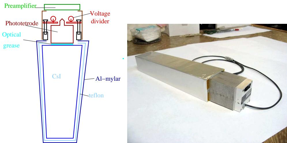
*Рис. 12: Схема и внешний вид счётчика.*
