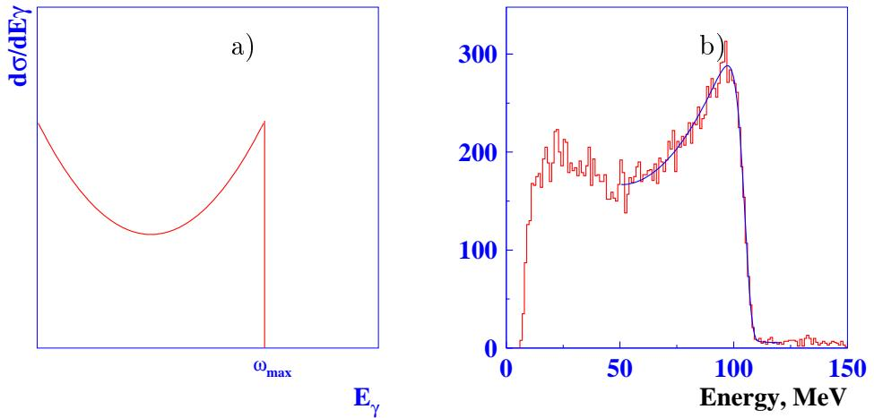
*Рис. 17: a) Спектр фотонов обратного комптоновского рассеяния. b)*
