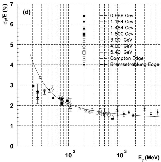
*Рис. 1:* Энергетическое разрешение калориметра детектора *Belle*, измеренное с прототипом калориметра ( $5 \times 5$ ) счетчиков [3].
