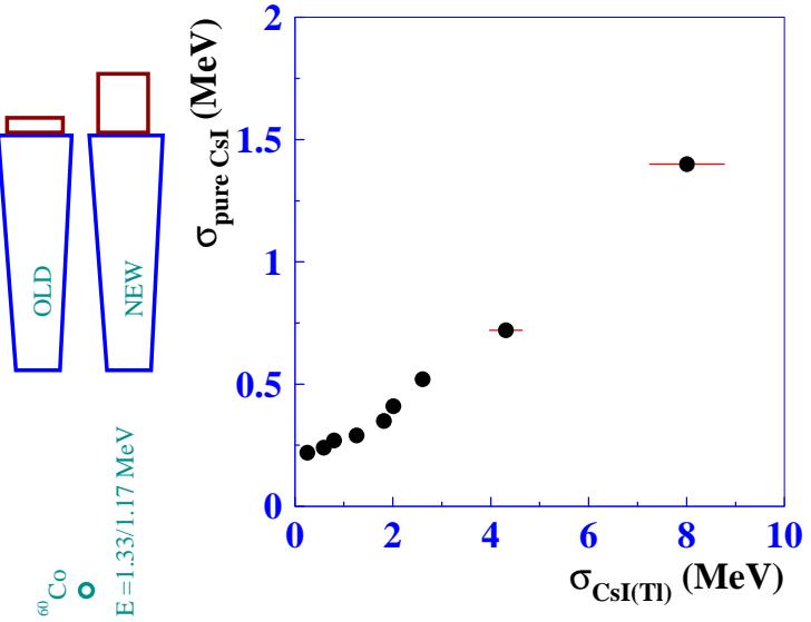
*Рис. 14:* Схема измерения *a)* и результаты измерения шумов наложения для счётчиков на основе чистого и активированного таллием кристаллов CsI *b).*
