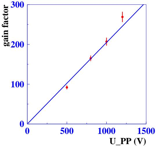
*Рис. 6:* Зависимость коэффициента усиления фотопентодов от приложенного напряжения.
