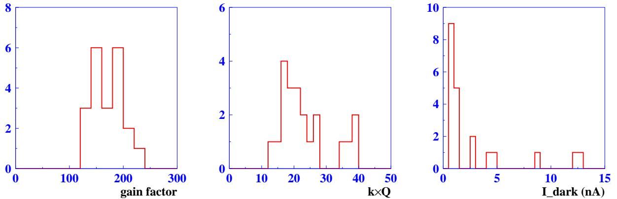
*Рис. 4: a) Коэффициент усиления; b) произведение квантовой чувствительности (%) на коэффициент усиления; c) темновой ток фотопентодов без магнитного поля.  $U=1000 \text{ В}$ .*
