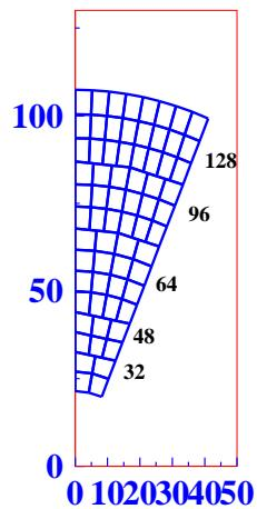
*Рис. 3: Расположение счётчиков в секторе торцевого калориметра*
