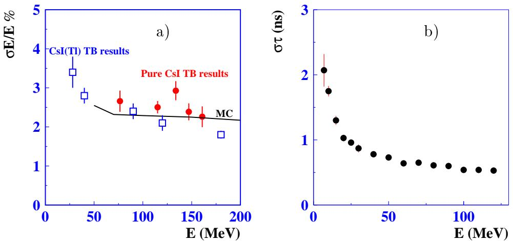
*Рис. 18:* a) Энергетическое разрешение, полученное на прототипе счётчиков чистого CsI. b) Временное разрешение полученное с прототипом.
