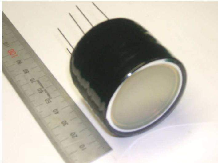
*Рис. 5: 2" вакуумный фотопентод (Hamamatsu Photonics).*
