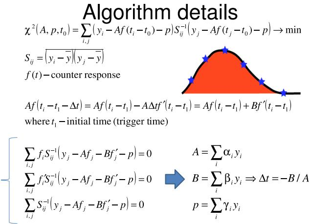
*Рис. 9: Алгоритм восстановления амплитуды и времени прихода сигналов*
