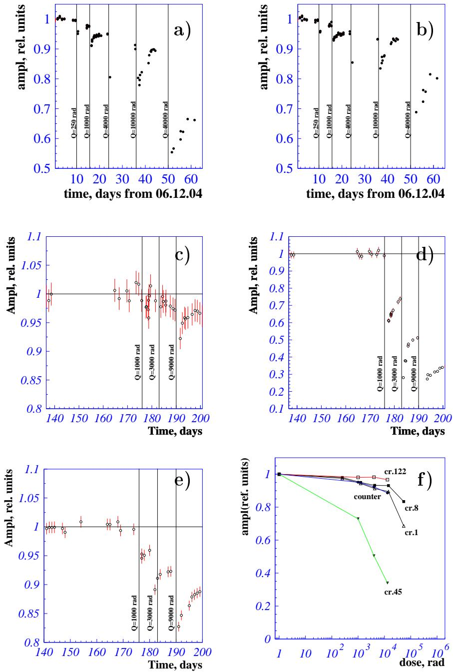
*Рис. 11:* Временные зависимости световыхода для различных кристаллов (a), (b), (c), (d) и собранного счетчика (e). Зависимости световыхода от поглощенной дозы (f).
