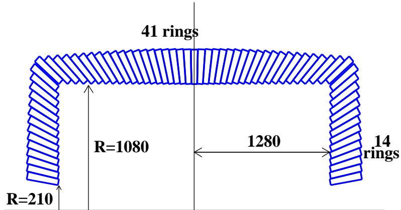
*Рис. 2: Расположение счётчиков в калориметре.* Цилиндрическая часть состоит из 128 секторов в азимутальной проекции, каждый из которых включает 41 кристалл 21-го типа-размера. Общее число счётчиков в такой компоновке – 5248, а полная масса кристаллов составляет 26 или 31 т в случае, когда длина кристаллов 30 или 34 см, соответственно.
